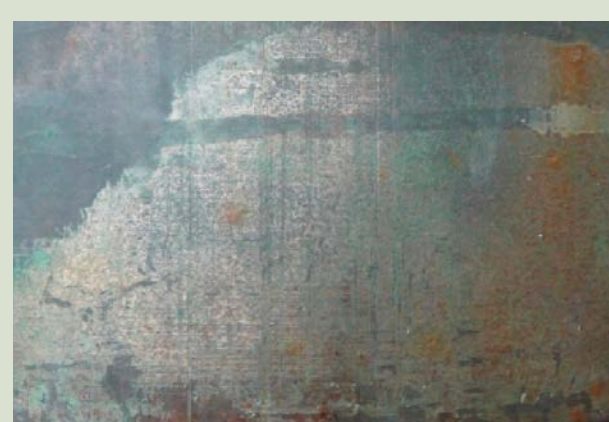
Сервовитная пленка на рабочей поверхности буксы шасси самолета ТУ-104
