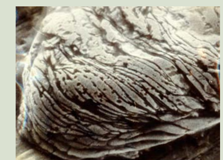
Частица износа, пронизанная микротрещинами
