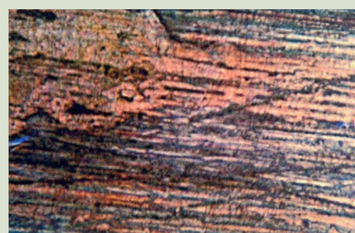
Сервовитная пленка на рабочей поверхности стойки шасси самолета
